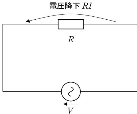
抵抗に流れている電流を  $I$  とすると、抵抗で生じる電圧降下  $V'$  の大きさがオームの法則より  $V' = RI$  で与えられるため、キルヒホッフの法則 II より、
