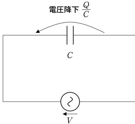
ある時刻  $t$  においてコンデンサーに蓄えられた電荷量を  $Q$  とすれば、コンデンサーで生じる電圧降下  $V'$  は
