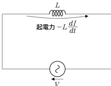
ある時刻  $t$  において回路を流れている電流を  $I$  とすると、コイルを流れる電流の時間変化は  $\frac{dI}{dt}$  であり、コイルには電流の増加を妨げる向きに起電力  $V' = -L \frac{dI}{dt}$  が生じる。キルヒホッフの法則 II (閉回路内の起電力の総和はその電圧降下の総和に等しい) より、
